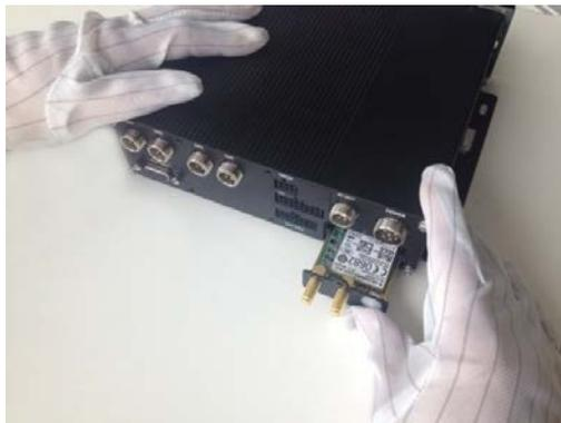
6. Установите обратно модуль и закрутите винт.
