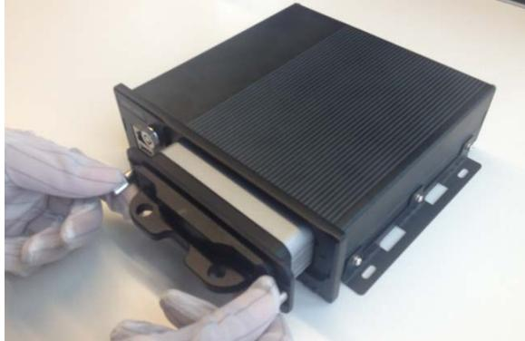
2. Вставьте ключ и разблокируйте жесткий диск, открутите винты против часовой стрелки и достаньте бокс для жесткого диска.
